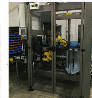
Le palettiseur Rpal (Duguit) prépare et oriente en amont le positionnement des produits.
