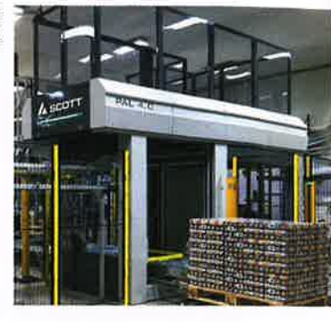
Le PAL 4.0 (Scott automation) dispose d'un tout nouveau système de poussée des couches dans le palettiseur.
