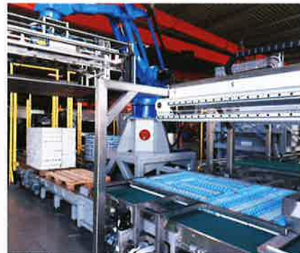
Le nouveau palettiseur à couches d'Ixapack Global peut prendre en charge un grand nombre de formats.
