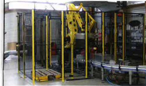
Le palettiseur de MG-Tech peut traiter une ou deux lignes juxtaposées en simultané.
