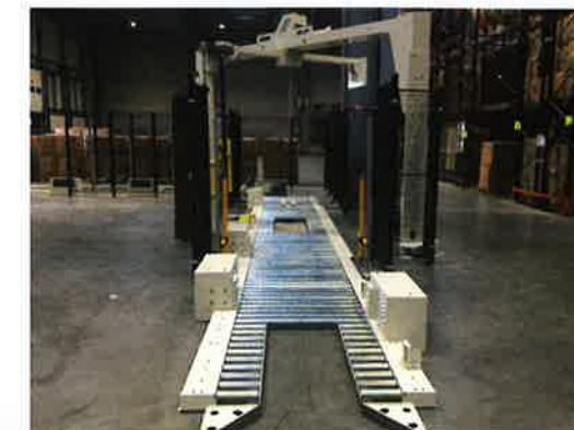
Dédiée à la palettisation de sacs, le Terram 800 G (Newtec Bag Palletizing) sécurise le travail des opérateurs grâce à sa maintenance au sol.
