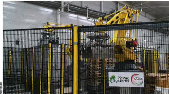
Grâce à la grande variété d'outils de préhension qu'il intègre, le robot palettiseur de Guelt traite tout type de colis.
