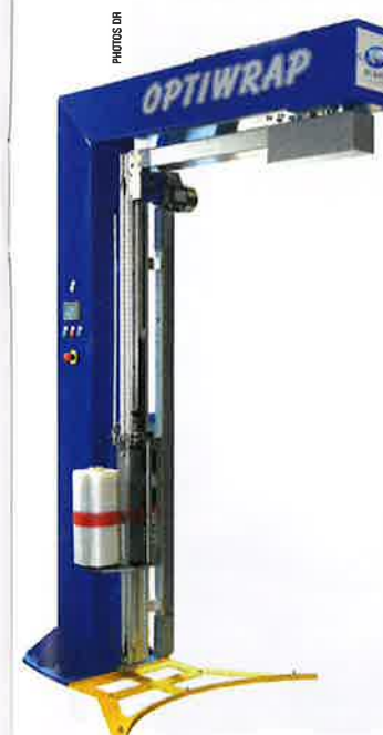
La banderoleuse à bras tournant Optiwrap de Rubafilm (groupe Cerclurop) travaille avec des bobines de film pré-étiré en usine (7 ou 9 µm).
