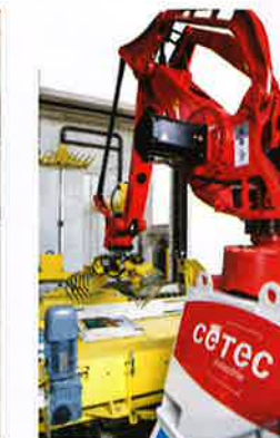
Le robot PAPR (Cetec industrie) permet une précision de dépose de 2 mm.
