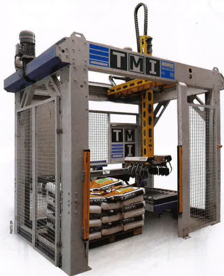
Le robot cartésien de TMI (distribué par PBH France), l'Ilerpal P, peut palettiser jusqu'à 420 sacs par heure.
