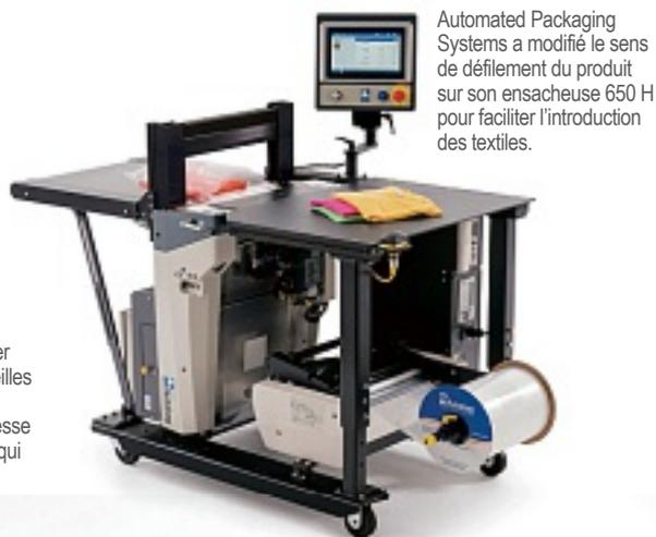
Automated Packaging Systems a modifié le sens de défilement du produit sur son ensacheuse 650 H pour faciliter l'introduction des textiles.
