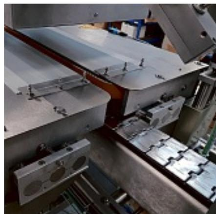
Grâce à l'intelligence artificielle, Langguth peut repérer et étiqueter en ligne des contenants cylindriques à une vitesse de 200 coups par minute.
