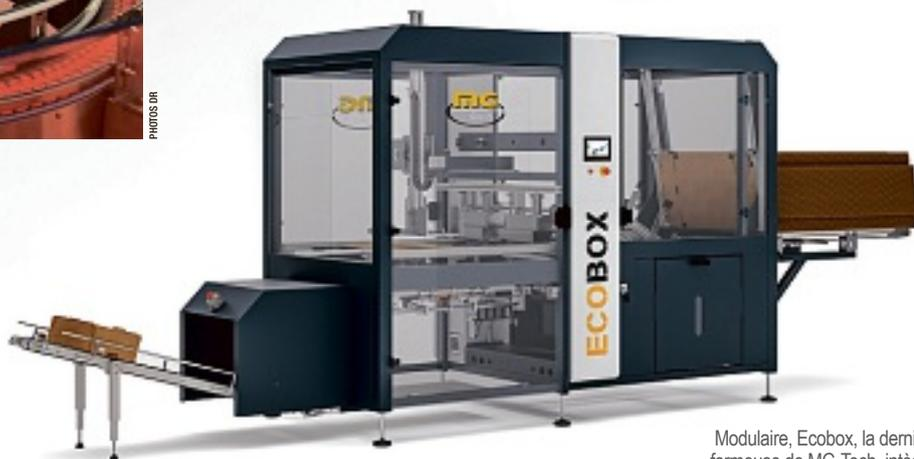
Modulaire, EcoBox, la dernière formeuse de MG-Tech, intègre, selon les besoins du client, un magasin à grande ou à faible capacité.
