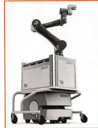
Plateforme robotique mobile et bras articulé de 12 kg de capacité de charge.
